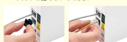
2 付属の電話線(黄色)のもう片方を、STEP1で抜いたお客さま宅内のモジュラージャックへ差し込む
